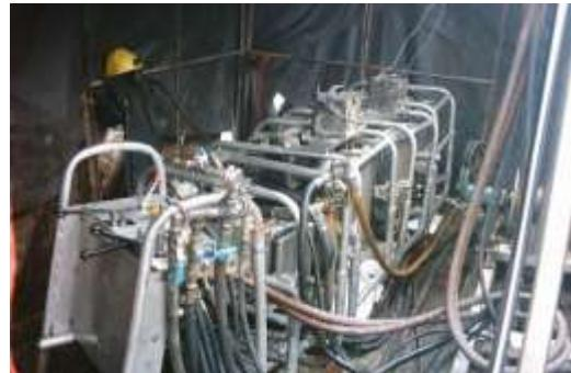
**Foto 6.10. Ensamblaje de la perforadora (Foto de archivo)**
